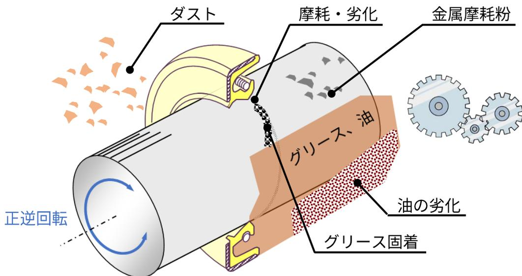
オイルシールの使用環境下では、外部ダスト、機械内部で発生した金属摩耗粉、熱で劣化した油やグリースの固着物などが存在し、それらがリップ先端部に噛み込み油漏れを起こす場合があります。
